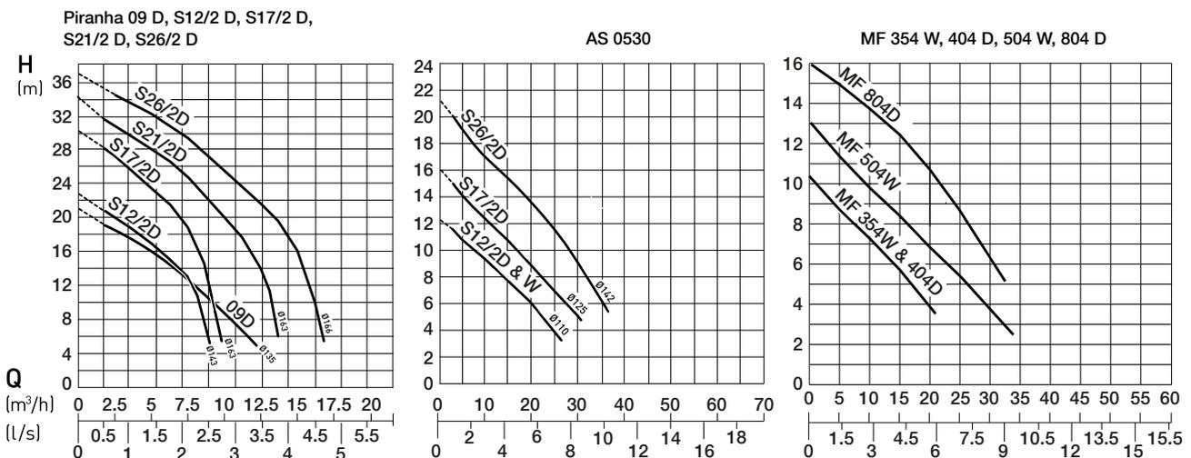
H = Gesamtförderhöhe; Q = Förderstrom. Kennlinien nach ISO 9906 (Kennlinien für 60 Hz auf Anforderung erhältlich)
